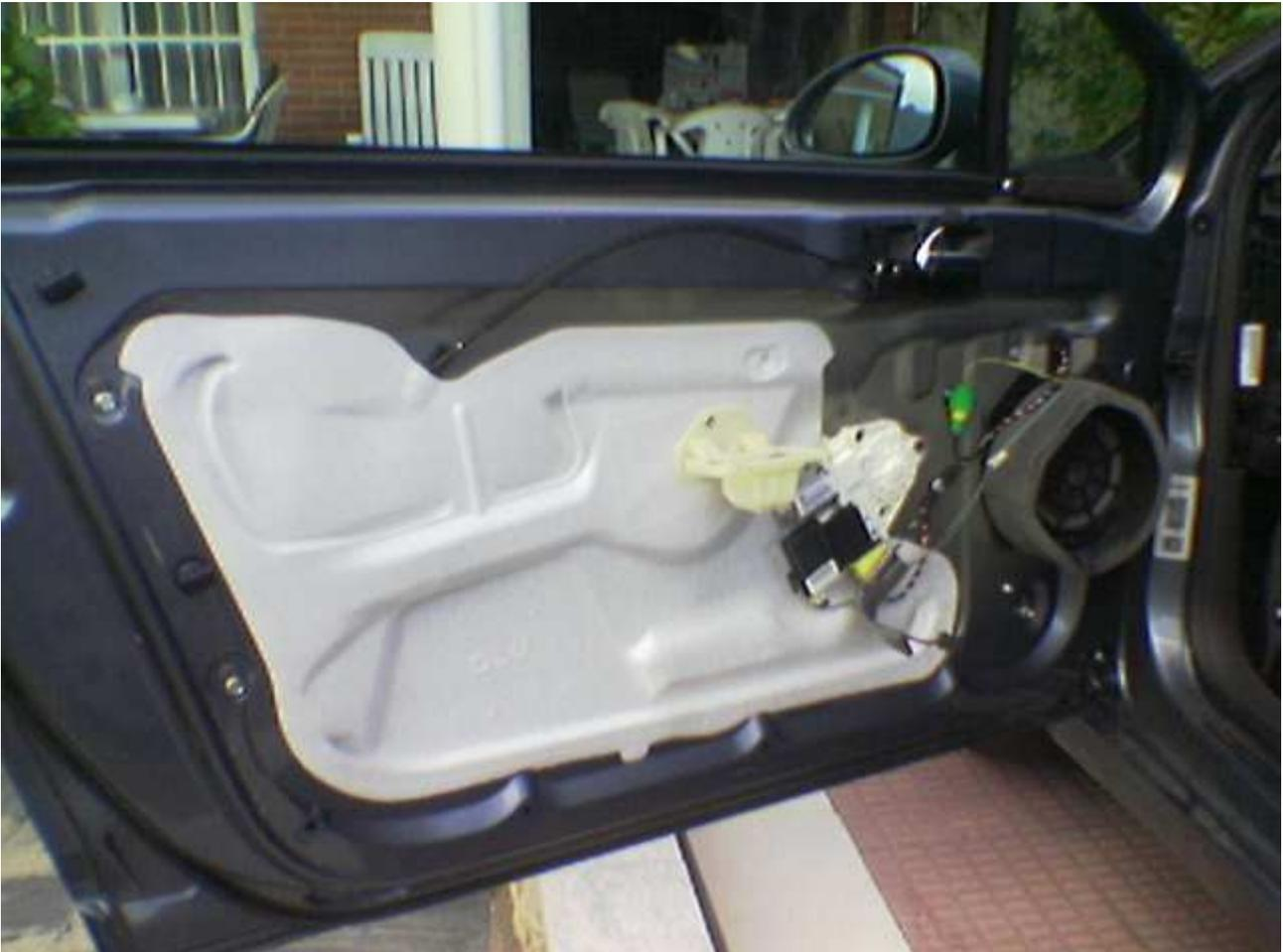
Son cuatro tornillos, dos en la parte izquierda del panel, otro en el hueco donde van los elevavinas y el ultimo en la esquina inferior derecha del panel
