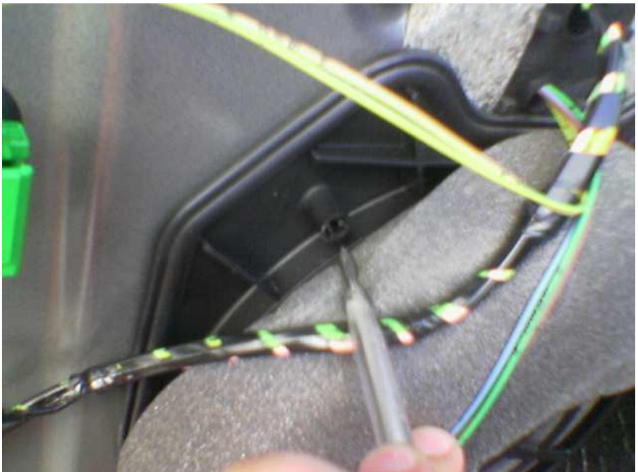
Cogemos un pasa cables, desmontamos la tapa del salpicadero (ni tornillos ni nada, va a presión), y en el caso de la puerta del copiloto bajamos la trampilla de los fusibles para poder acceder a la goma pasa cables.
