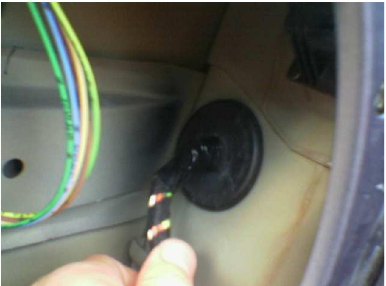
Para ello veremos directamente dicha goma en la puerta del copi, pero en la del conductor es algo mas complicado (no mucho). En la del piloto deberemos desmontar una rosca que sujeta al chasis una especie de tela aislante.
