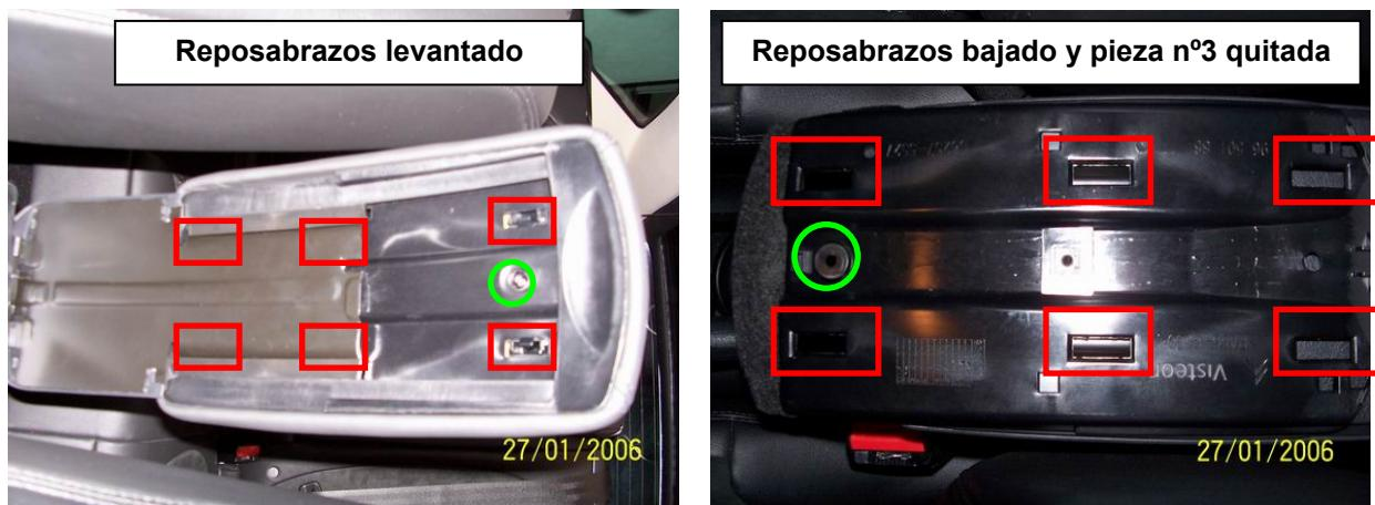
2º - Desmontamos la pieza nº2. Esta pieza se desliza libremente sobre los raíles, de modo que sale muy fácilmente empujando como indica la flecha.
