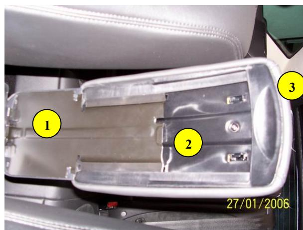
1º - Desmontamos la pieza nº3. Para esto hay que quitar el tornillo y las 6 pestañas marcadas en la foto. Mucho cuidadín con las pestañas para no romperlas. Las 2 de la parte superior y las de la zona central se pueden ver, pero las de la parte inferior no. El tornillo es de tipo Torx.
